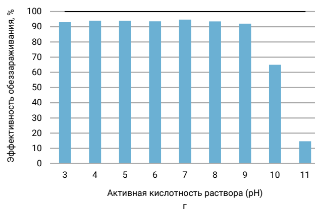
Рисунок 2. Влияние pH растворов на эффективность бактерицидного действия диоксида хлора относительно тест-культуры Bacillus subtilis при концентрации диоксида хлора: а) 1,0 %; б) 0,75 %; в) 0,5 %; г) 0,25 %
