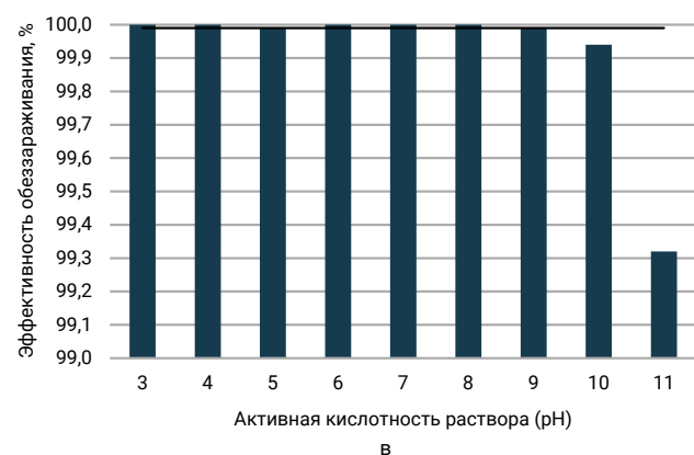
Рисунок 2. Влияние pH растворов на эффективность бактерицидного действия диоксида хлора относительно тест-культуры Bacillus subtilis при концентрации диоксида хлора: а) 1,0 %; б) 0,75 %; в) 0,5 %; г) 0,25 %
