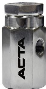
**Вентили запорные сильфонные.** Абсолютная герметичность вентиля класса А обусловлена рядом конструктивных особенностей, выгодно отличающих его от стандартных аналогов, в частности — коническая уплотнительная поверхность затвора. Вентиль не требует обслуживания — в конструкции использован сильфон вместо сальника. Сменные седло и плунжер позволяют осуществлять ремонт без демонтажа с трубопровода.
