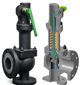
шения предельно допустимого давления. Абсолютная герметичность класса А, в том числе в исполнении «металл по металлу», обусловлена рядом конструктивных особенностей, разработанных собственным конструкторским департаментом завода. Благодаря модернизации узла подрыва увеличена точность настройки клапана. Сменные внутренние части позволяют производить быстрый ремонт.
