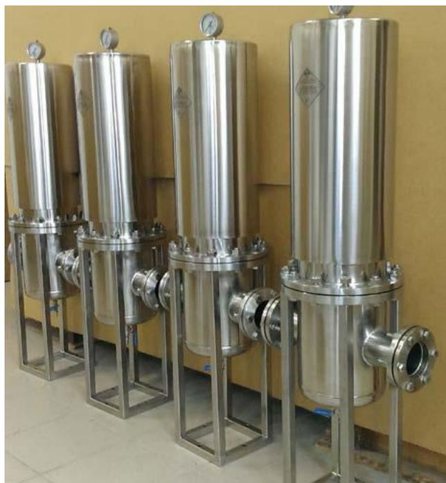
Рисунок 1. Многopatронные держатели для фильтрации пара ДФП-206Р
